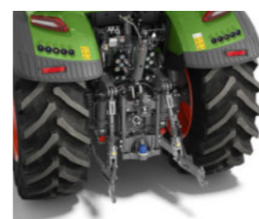
Elevador hidráulico trasero con gancho de enganche rápido y apoyo lateral (UE)
