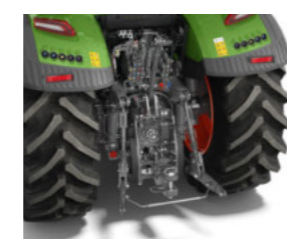
Elevador hidráulico trasero con enganche esférico y Rub Blocks
