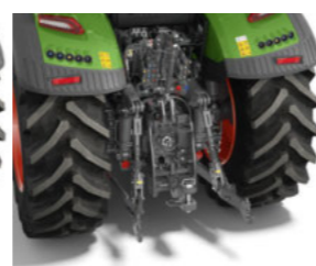
Elevador hidráulico trasero con gancho de enganche rápido y Rub Blocks (AU, Sudáfrica, Europa Oriental)
