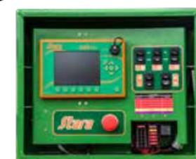
Controla el sistema de tratamiento de la máquina, que acciona los actuadores cada uno independiente. A través del panel electrónico se puede regular los flujos, hacer calibraciones y comenzar o parar el trabajo.
